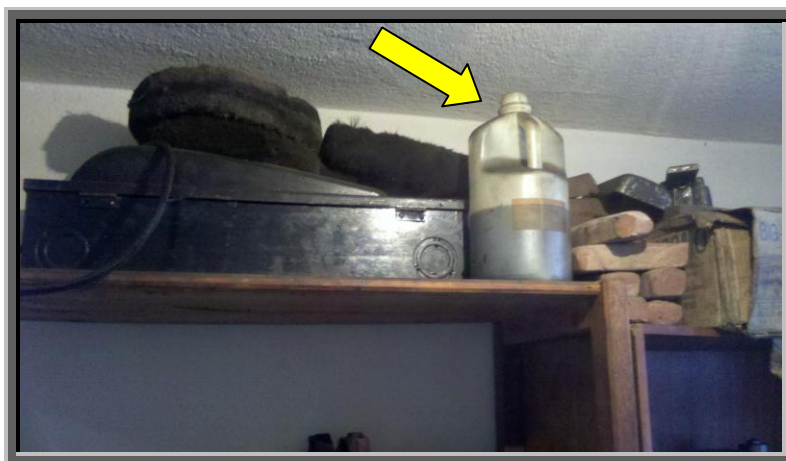
Figura 4.5 – Recipiente contendo óleo de corte guardado em local indevido
