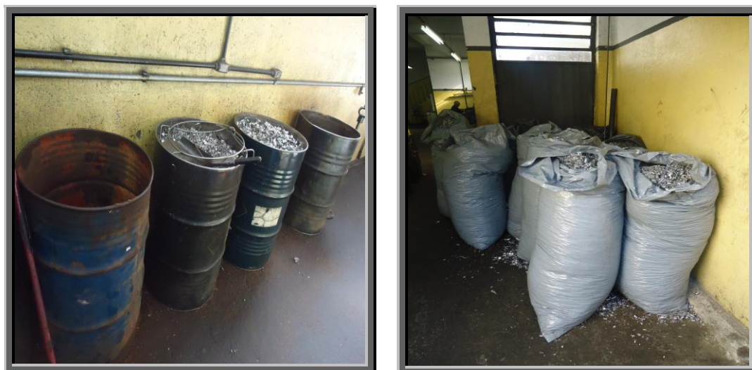
Figura 4.15 – Tambores e sacos usados para acondicionar cavacos
